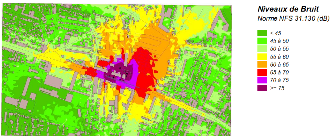
Figure 15 – Niveaux sonores en dehors des bâtiments exprimés par tranche de 5 dB(A)
